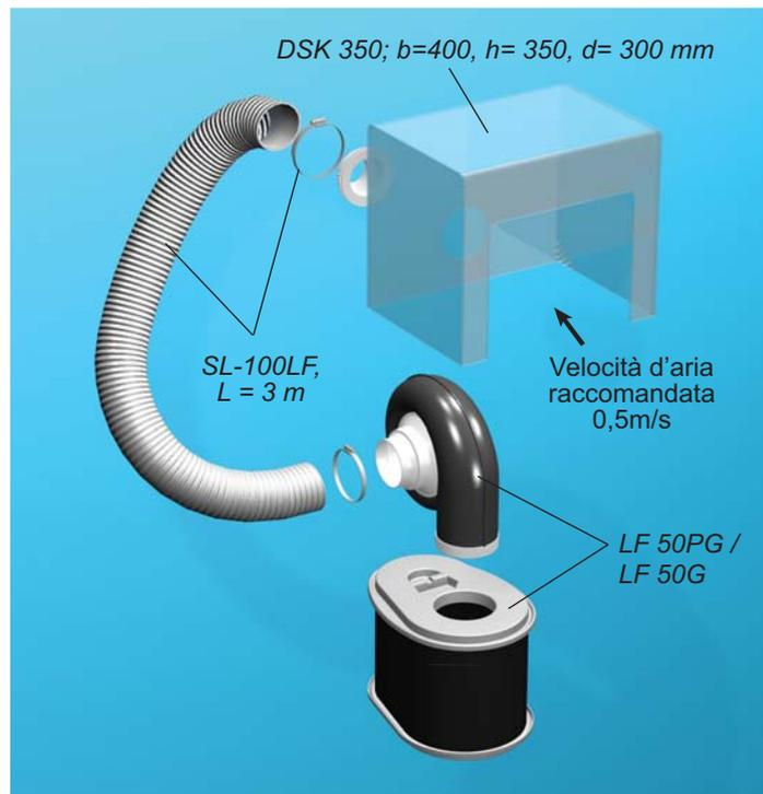
LFK 350C con la sua cabina trasparente in policarbonato realizza un'efficiente contenimento delle sostanze inquinanti al suo interno lasciando filtrare la luce. La cabina DSK 350 viene collocata sul banco di lavoro ed è pronta all'uso. Questa unità filtrante è particolarmente vantaggiosa nei casi in cui ci sia la necessità di un'alto livello di captazione e di filtraggio di particolato e gas.
