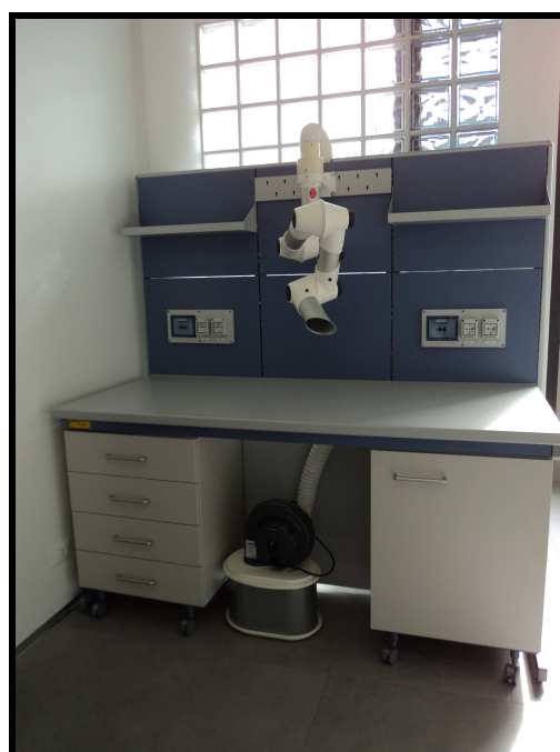
24) banco parete con alzata tecnica Modulab 95 completo di cappa d'aspirazione localizzata con filtro, in particolare configurazione per Laboratorio Farmacie
